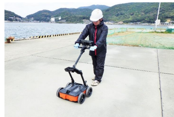
空洞化調査 (レーザ法)
