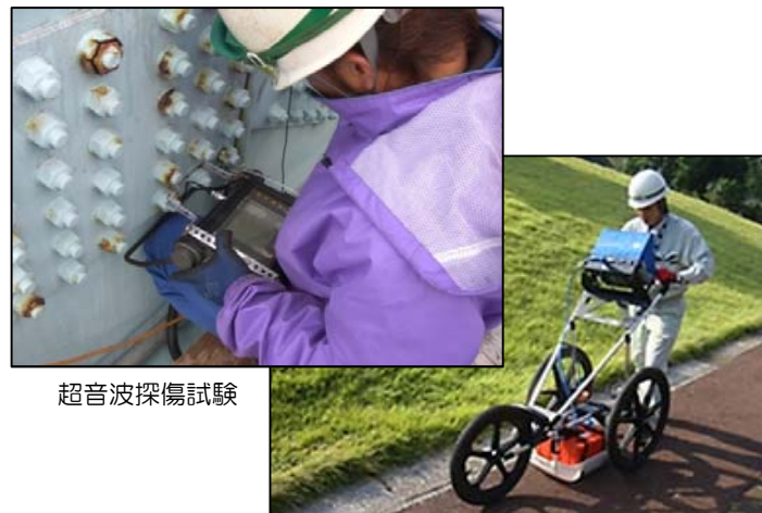
電磁波レーダーによる地下空洞・埋設物調査
