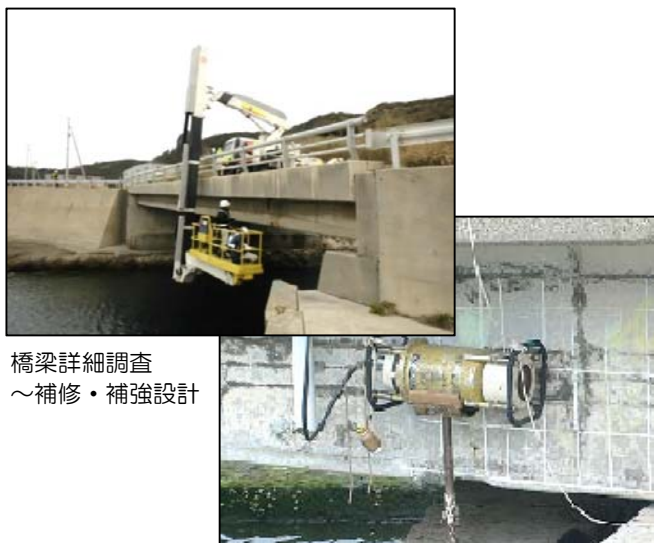
放射線透過撮影法による躯体内部調査
