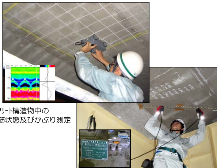
微破壊・非破壊試験による コンクリート構造物中の強度測定試験
