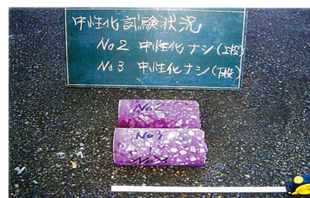
◎コンクリート試験（圧縮強度・中性化・塩化物 他）
